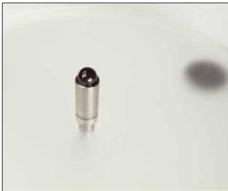
*Die Stahlachse mit eingepresster Lagerkugel*
